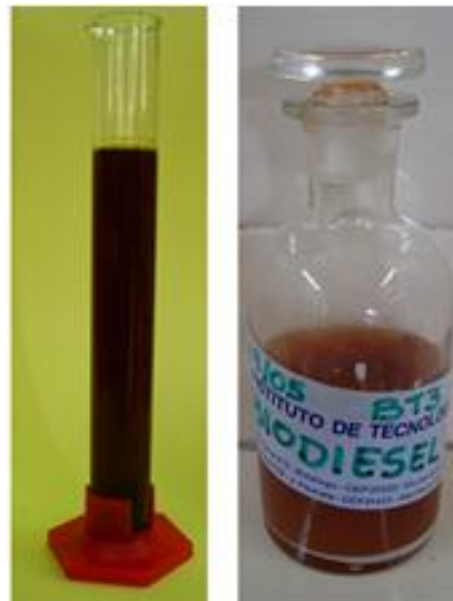
Figura 2: O óleo de cozinha usado e o biodiesel obtido
